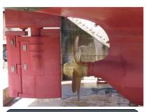
CONV' RUDDER SYSTEM (CRS)
